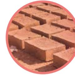
6. Una vez que los ladrillos pueden ser manejados sin ser deformados, se van moviendo por tal que el secado se produzca de manera uniforme.
