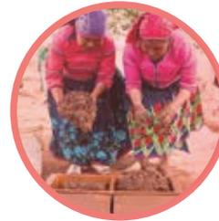
4. Agregamos grandes bolas de mezcla hasta llenar el molde, presionamos desde el centro hasta las orillas. Vamos aparejando con las manos la mezcla en el interior del molde hasta conseguir el llenado total del molde. Con el mismo molde podemos realizar más de un ladrillo o adobes.
